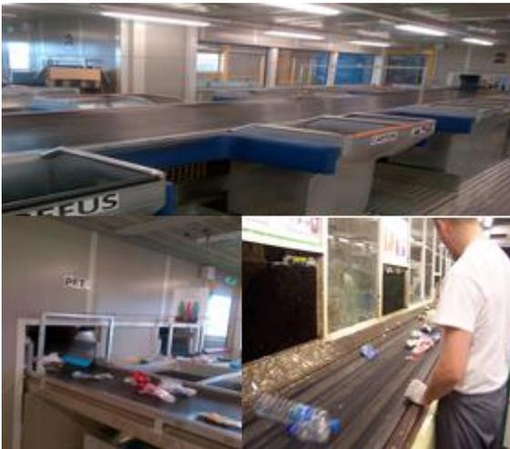
Le contenu des bacs jaunes et des points éco-propreté est pré trié sur une chaîne mécanique avant d'être trié manuellement en cabine.
